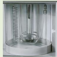
槽内に冷却パイプを設け、冷水を循環させることで室温以下の測定が行えます。
